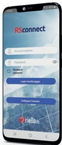
RS Connect se convierte en fundamental para la ejecución automática del Autotest con liberación de informes y para la configuración de la dirección IP necesaria para la conexión Wi-Fi con su router. También es posible mostrar todos los parámetros de CC (voltaje y corriente de entrada del inversor) y los parámetros de salida del inversor de AC
