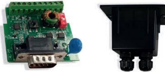
Ranura de expansión DB9 usada para tarjetas de comunicación opcionales, por ejemplo RS485.
