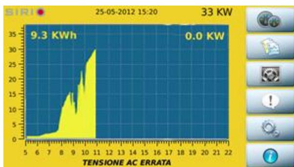
**ALARMAS:** Uno sfondo di colore AMARILLO significa che le condizioni di irradiazione sono buone, ma l'inverter non parte a causa di problemi temporanei come, ad esempio, una tensione inadeguata della rete, un eccesso di temperatura dell'inverter, ecc. Nella parte inferiore dello schermo si trovano una serie di messaggi che spiegano il tipo di allarme. Vedere la sezione seguente per la spiegazione di questi.
